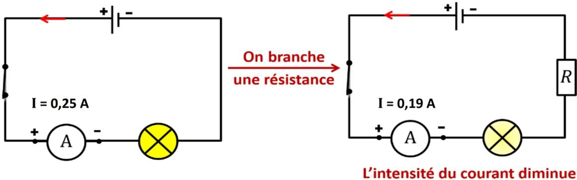
Chaque résistor est caractérisé par une capacité à résister au passage du courant électrique qui varie d'un résistor à un autre, c'est une grandeur physique appelée résistance électrique, son symbole est R et son unité de mesure universelle est l'Ohm ( $\Omega$ ).
